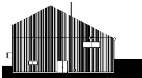
Tous les murs extérieurs seront isolés par l'extérieur avec une isolation de 20 cm de produit machine et l'isolation sera protégée par le même Bacacier de couleur VOLCANO
