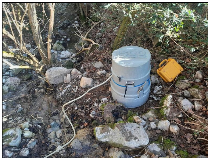
Figure 3 : Exutoire Est – Echantillonneur ISCO 3700 et débitmètre Sigma 950
