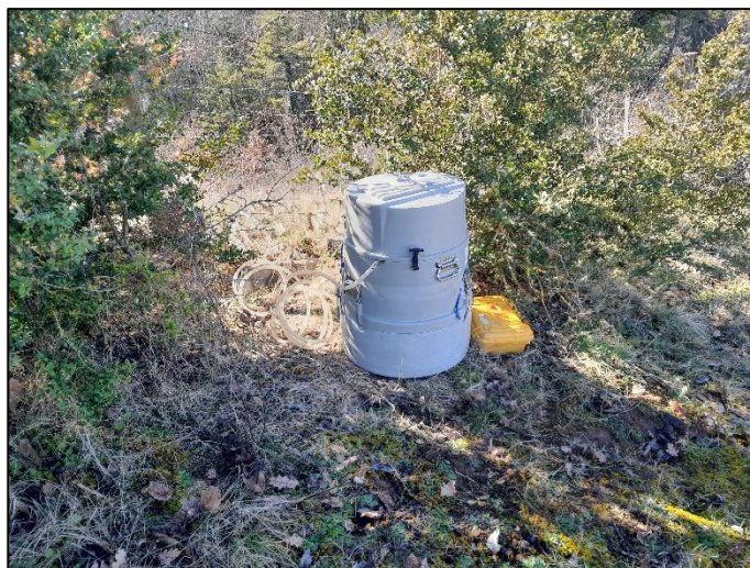
Figure 5 : Exutoire Ouest – Echantillonneur ISCO 3700 et débitmètre Sigma 950
